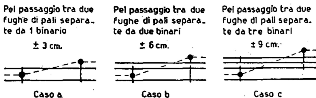
Fig. 163. - Strapiombi da dare ai pali portanti condutture di alimentazione, all'atto del montaggio
