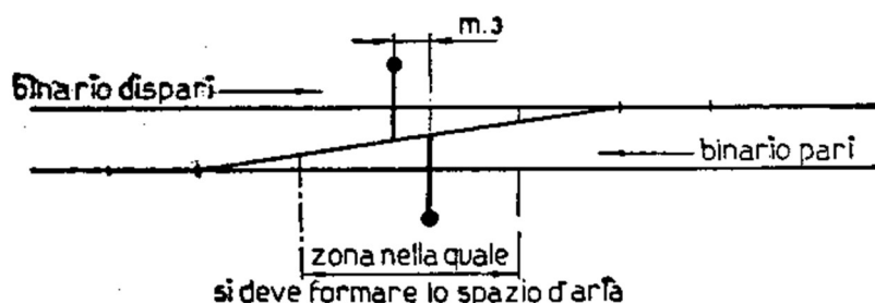
Fig. 162. - Disposizione dei pali nella zona dello « spazio d'aria »
